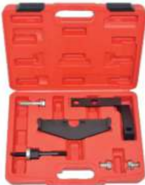
562-250 Timing tool BMW R50 / R52 / R53 W10 / W11
